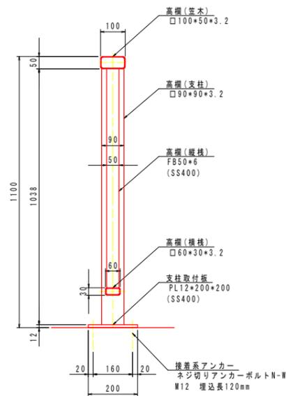
支柱取付板詳細図 S=1:4
