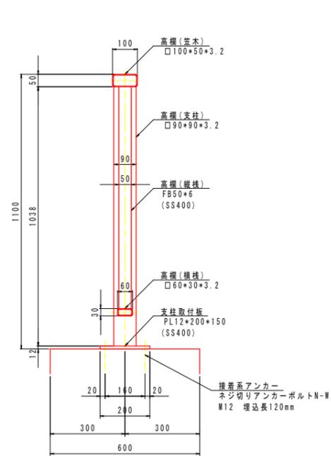
支柱取付板詳細図 S=1:5
