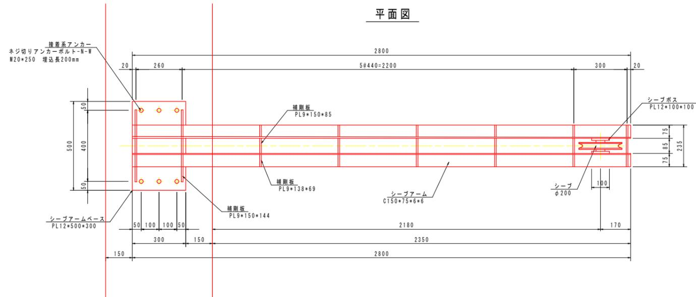
開閉機架台構造図
